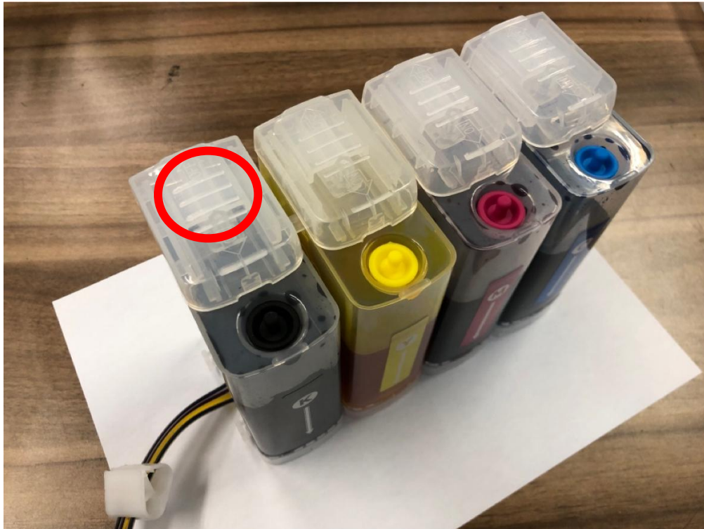
① インク上部カバーoff状態
